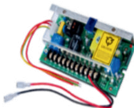
FUENTE DE PODER PARA CONTROL DE ACCESO
